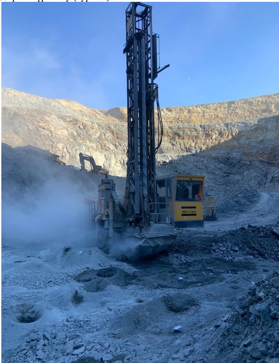
Сурет 6 - СБШ-250 МН-32 бұрғылау станогының ұңғымаларды бұрғылау кезіндегі көрінісі.
